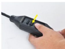
2. Presione el botón «RESET», la luz indicadora se vuelve roja.
