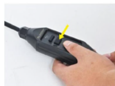
4. Presione el botón «RESET», la luz indicadora se vuelve roja. El RCD funciona correctamente.
