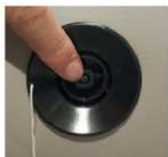
Presiona directamente hacia abajo el resorte dentro de la válvula para desinflar.
