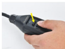
3. Presione el botón «TEST», la luz indicadora se apaga.
