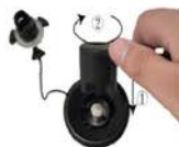
Aprete la válvula de aire con herramientas.
