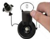
Utilice herramientas para desenroscar el eje de la válvula de aire.
